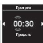
Включается отопление. На дисплее показан пункт меню "Отопление", а также предустановленное оставшееся время работы. Кнопка быстрого старта горит зелёным светом.
